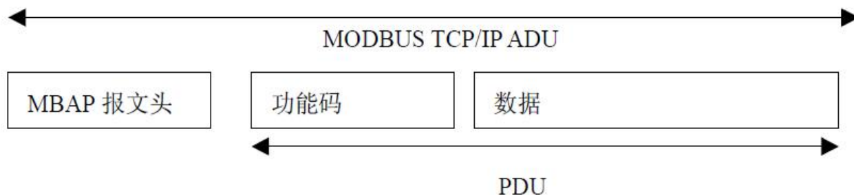
图 6: TCP/IP 上的 MODBUS 的请求/响应
