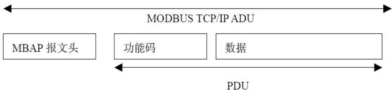
图 6：TCP/IP 上的 MODBUS 的请求/响应
